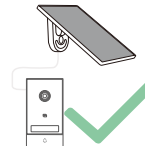
Sikre at strømkabelen ligger naturlig uten spenning
